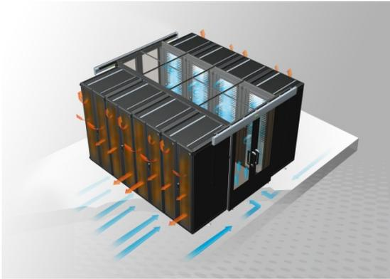
L'installation d'un couloir thermique permet de séparer physiquement l'air froid aspiré et l'air chaud rejeté par les matériels.
